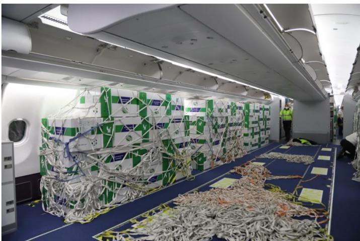
**圖片說明：**改裝後的空客A330客機內部空間可達250立方米，每次飛行可以運輸大約200萬個新冠檢測試劑盒。（來源：吉布達偉士、Robert Lang）
